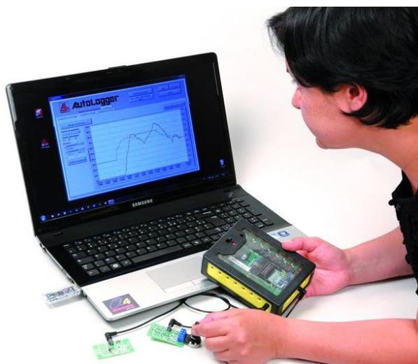
**AutoLogger** est une application fonctionnant avec le système AutoProg® V2 dont le cœur est un microcontrôleur PICAXE 28X2.
