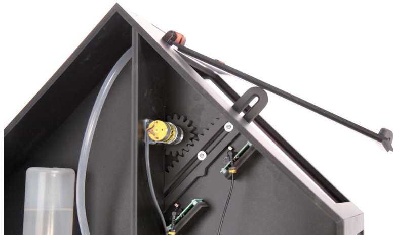
Microrupteur pour gérer le mécanisme à crémaillère de l'ouverture et de fermeture du plafond de la mini-serre.
