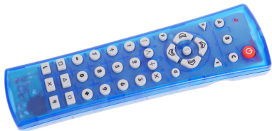
La télécommande permet la mise en marche et l'arrêt de l'alarme en tapant un code.
