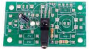
Module récepteur infrarouge Réf. : K-AP-MRIR-M
