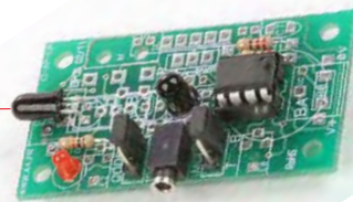
Module émetteur infrarouge Réf. : K-AP-MEBIR-M
