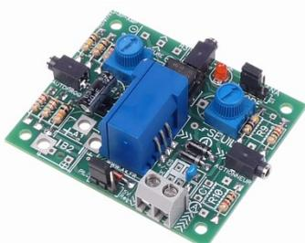
**Module capteur de courant**
