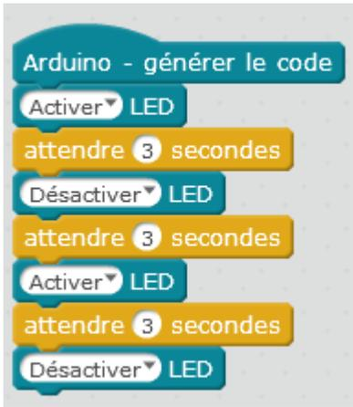
Le programme de correction est une séquence de blocs mBlock : 'Arduino - générer le code' (bleu), 'Activer LED' (bleu), 'attendre 3 secondes' (orange), 'Désactiver LED' (bleu), 'attendre 3 secondes' (orange), 'Activer LED' (bleu), 'attendre 3 secondes' (orange), et 'Désactiver LED' (bleu).
