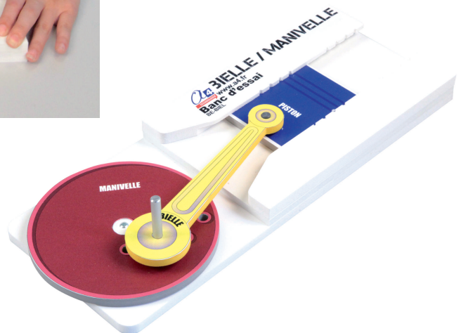
Systeme de transmission de mouvement par bielle et manivelle
