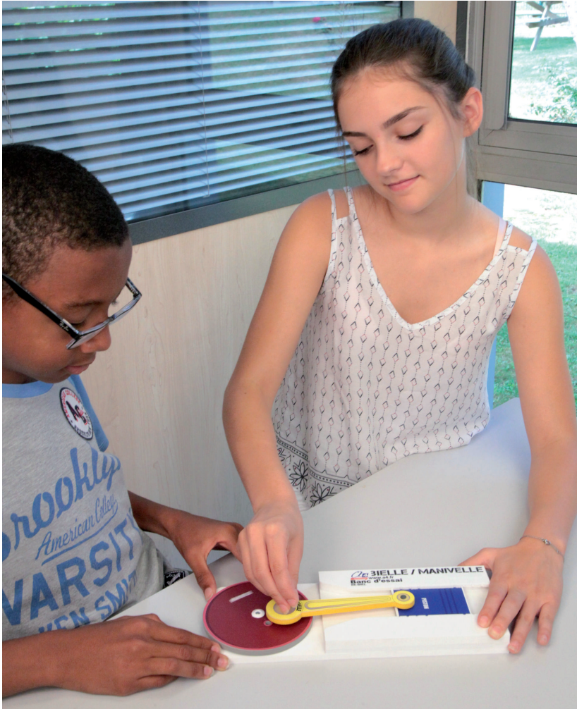
Systeme de transmission de mouvement par bielle et manivelle
