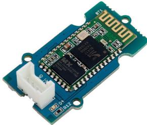
**Description** : permet d'établir une communication sans fil entre le matériel et une application sur smartphone ou tablette.
