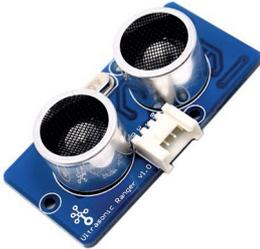
**Description** : mesurer la distance qui sépare le capteur d'un obstacle.
