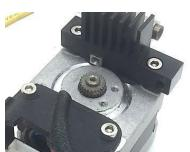
La position de l'extrudeur est au raz du radiateur, côté mollette du moteur.
