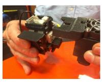
Le remontage s'effectue à l'inverse du démontage : présenter le carter par l'avant ; le mettre en place en l'emboitant dans les rainures.
