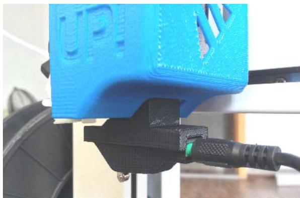
Vous devez le brancher à l'arrière de l'imprimante par le biais du câble jack 3,5 mm en veillant à ce que le fil passe bien par l'extérieur du cadre pour ne pas entraver le déplacement de la plateforme.
