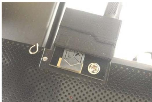
Il est fixé à l'imprimante à l'aide d'une vis et relié à l'imprimante par le câble jack 3,5 mm. Une fois branché, cliquez sur **Nozzle Height Detect** à partir du menu **Impression 3D**.
