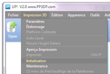
Normalement, l'imprimante émet 4 bips et la procédure d'initialisation débute. Elle fait sa prise d'origine et émet à nouveau un bip lorsqu'elle est prête.
