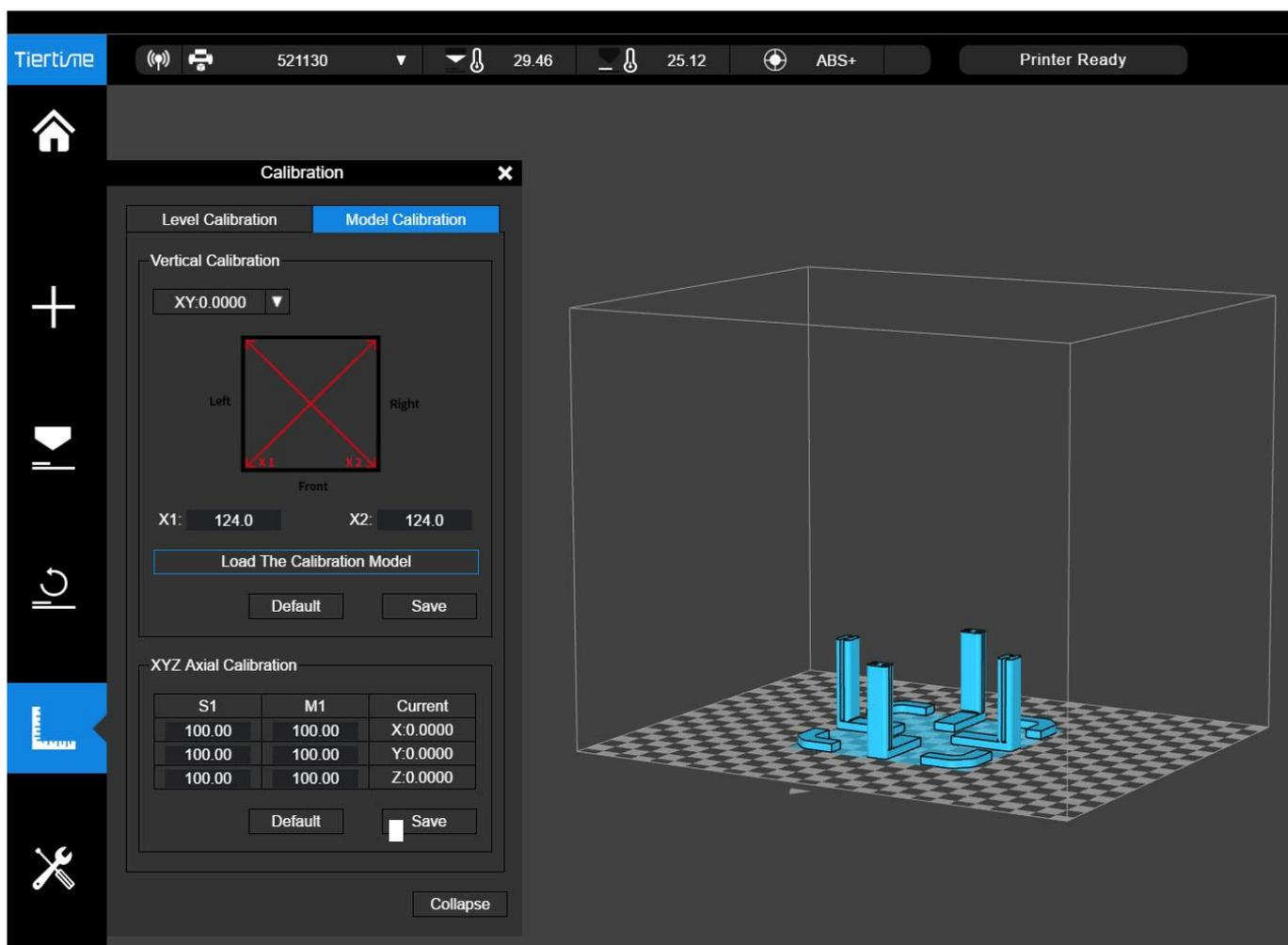
Cliquer sur l'onglet « model calibration » et « load the calibration model » pour charger le modèle de calibration à imprimer.
