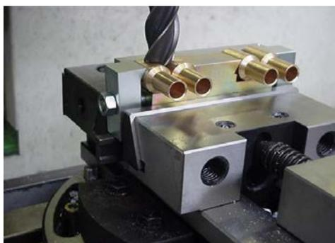
Ces 5 montages d'usinage font une très bonne approche en préparation du travail. Simples d'utilisation, ils sont opérationnels immédiatement. L'économie de mouvements et la fabrication sérielle est soulevée. La qualité de fabrication est assurée ; surtout pour des opérations diverses et délicates. Finition : qualité soignée et traités 60 HRc ; les surfaces sont rectifiées et protégées. Présentation en mallette avec notice d'utilisation. L/H/P : 222 x 39 x 160 mm. – Masse : 2,1 kg
