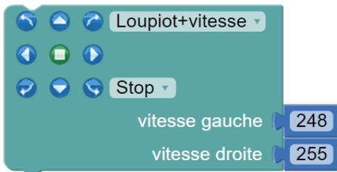
Ce bloc est réservé à la modification de la vitesse de déplacement du robot.
