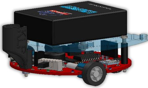
L'option porte-stylo permet de transformer le Loupiot en robot dessinateur.
