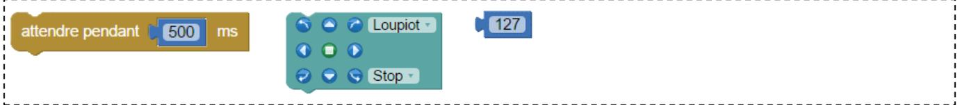
Ajouter l'option vitesse sur le bloc de contrôle des moteurs :
