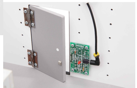
La porte et les deux fenêtres sont protégées par des modules ILS.
