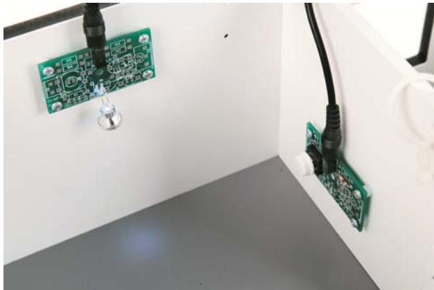
Détail de la fixation d'un module éclairage et d'un module bouton poussoir
