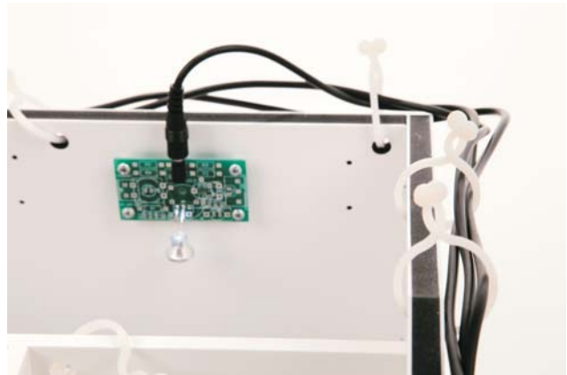
Détail du passage des câbles maintenus sur le haut des murs par des attaches câbles
