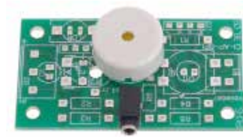
Module Buzzer - Réf. K-AP-MBUZ-M
