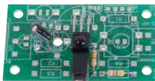
Une seconde barrière infrarouge
