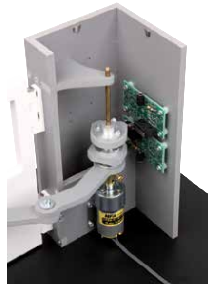
Transmission de mouvement par un bras articulé
