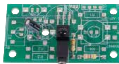
Module récepteur pour barrière infrarouge Réf. K-AP-MRIR-M
