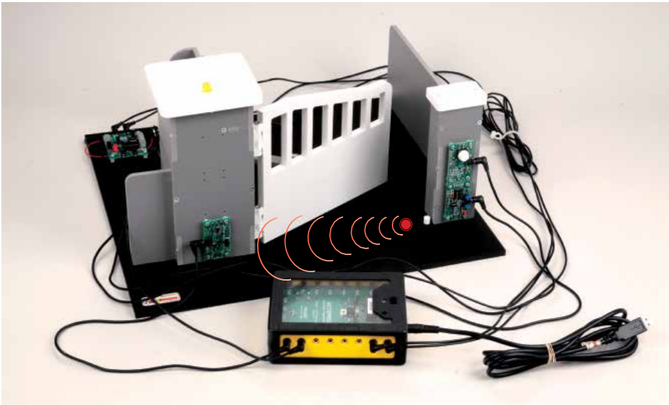
Maquette du portail battant un vantail et boîtier de commande AutoProg®
