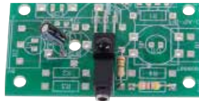
Module récepteur pour barrière infrarouge Réf. K-AP-MRIR-M
