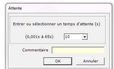
La modification du délai d'attente à 10 secondes a permis d'allonger le temps de passage d'une personne ou d'un véhicule d'un côté à l'autre du portail battant automatisé. Cela permet de protéger les personnes et/ou les véhicules d'un choc (écrasement, entraînement, coincement, etc.).
