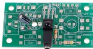
Module AutoProg Récepteur Infrarouge + Télécommande : pour déporter les boutons d'appels.
