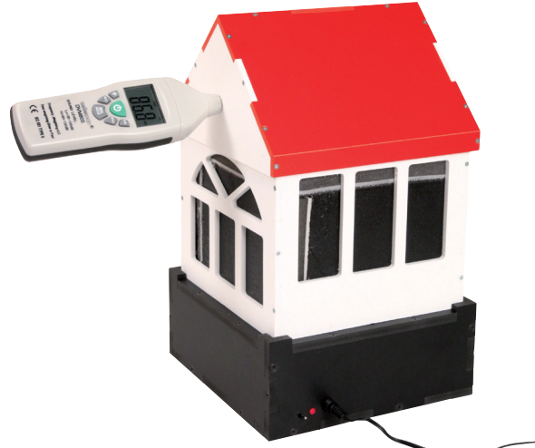
2. Banc d'essai acoustique avec un sonomètre (option).
