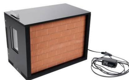
Banc d'essai avec mur en briques creuses
