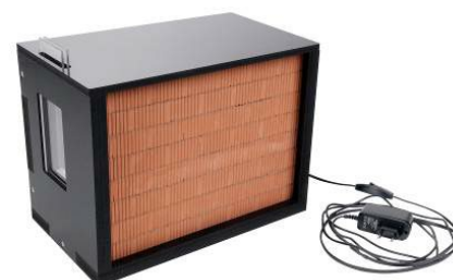
Banc d'essai avec mur en briques creuses
