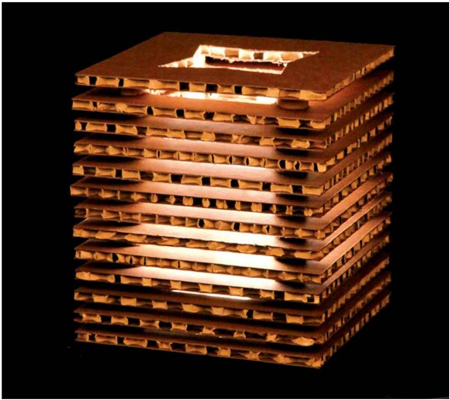
Lampe réalisée en carton alvéolaire 8 mm classé M1 au feu, avec ossature constituée de 4 tubes carton 18 x 25 mm. Éclairage par lampe à incandescence 15 W - 12 V sur douille E14, avec transfo d'alimentation surmoulé. Les pièces carton format 200 X 200 mm peuvent être découpées manuellement ou sur mini-fraiseuse CN. Dans le cas d'une découpe manuelle, pour les trous ronds, on devra utiliser un emporte-pièce Ø 25 mm ou une petite scie cloche.
