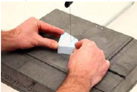
Découpe : ici au fil chauffant (Machine Styro-Cut 3D) en suivant le profil papier.
