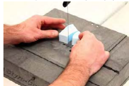
Découpe : ici au fil chauffant (Machine Styro-Cut 3D) en suivant le profil papier.
