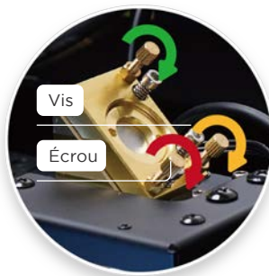
Les directions de rotation du miroir vis de réglage de la troisième miroir réfléchissant.
