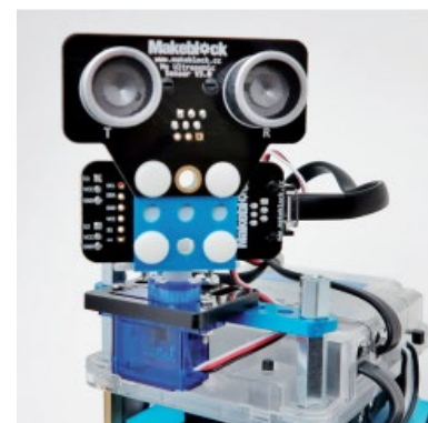
La photo illustre un exemple de tourelle avec un télémètre.
