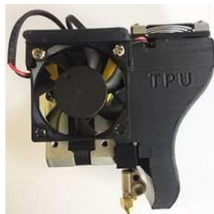
A gauche, la tête d'impression matériaux souple. A droite, modification de la fixation du ventilateur pour que cette tête soit utilisable sur UP BOX.
