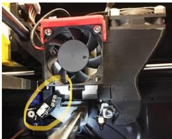
Photo de profil de la tête d'impression d'une UP BOX : on voit le capteur d'autolevel en position haute. Si le ventilateur était fixé plus bas, le capteur ne pourrait pas passer.
