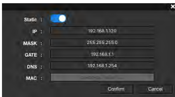
Figure 6.8 Paramètres réseau Ethernet
