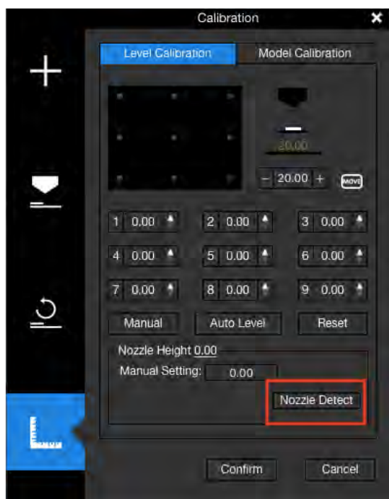
Illustration 6.17 Détection de buse
