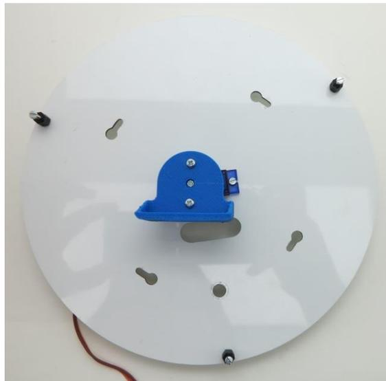
**A5** Monter le servomoteur sur la pièce 3D et le fixer avec 2 vis (TF M2 x L8 mm) et 2 écrous M2.
