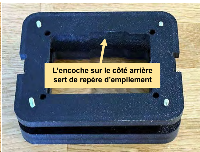
b – emboîter successivement les 4 autres plaques en les enfilant sur les vis. Ici les 2 plaques n°3
