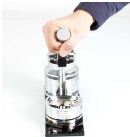
Remarque : Après une utilisation prolongée de la machine à badges, les butées intérieures des outils de formage peuvent se désaligner ; si nécessaire, elles peuvent être réajustées à l'aide d'un tournevis cruciforme.
