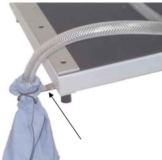
3. Installez l'ouverture du sac à copeaux au centre du support. Tirez le tissu sur la partie cylindrique du support et fixez-le en tirant le clip à ressort vers le bas sur le tissu et le cylindre.
