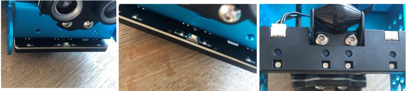
Capteur quadruple RVB, vue de face
