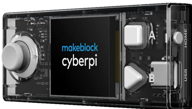
Un CyberPi est monté sur le mBot2. Un CyberPi est un petit micro-ordinateur programmable. Vous transmettez des commandes au CyberPi en utilisant les blocs de code dans mBlock. Le CyberPi transmet ces commandes au mBot2. Vous pouvez retirer le CyberPi du mBot2.
