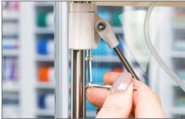
8. Serrez ou desserrez la vis à l'aide de la clé hexagonale. Pour les points « Facile », tournez la clé hexagonale dans le sens antihoraire. Pour les points « Difficile », tournez la clé hexagonale dans le sens horaire.
