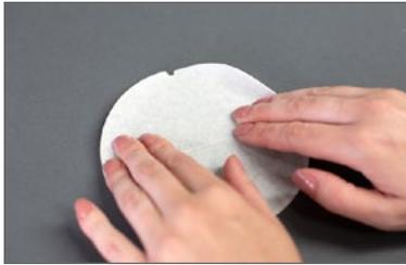
5. Encore une fois, assurez-vous qu'il n'y a pas de bulles ou de plis. Si la bande n'est pas posée à plat contre la plate-forme, votre objet 3D ne sera pas imprimé correctement.
