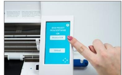
1. Allumez votre Silhouette Cameo® et insérez votre clé USB dans le port USB situé sur le côté de la machine.
