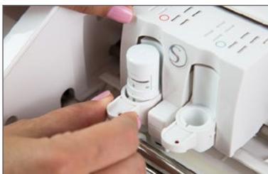
1. Pour retirer la lame, tirez doucement sur le rebord du porte-outil. Ceci dégage une petite pièce qui permet de retirer la lame du porte-outil.
