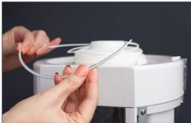
7. Et puis à travers le tube à filament.
