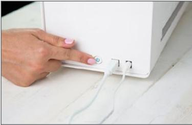
1. Allumez votre Curio par le bouton de mise sous tension situé sur le côté droit de la machine.
