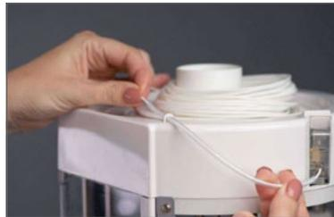
8. Assurez-vous de pousser le tube légèrement en arrière dans la boucle. Dans le logiciel, cliquez sur « Suivant ».
