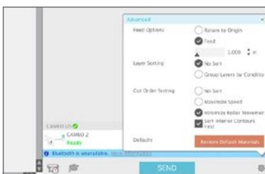
2. Dans le panneau Envoyer, accédez aux paramètres avancés. Sélectionnez « Alimentation » dans vos options d'alimentation. Réglez la distance de fin de sorte que le matériau soit alimenté par l'arrière de la machine.
