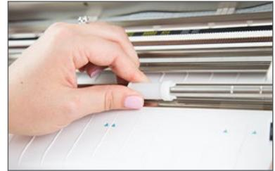
3. Réglez le rouleau coulissant au format de média souhaité et tournez à nouveau pour mettre les ergots en place. Les quatre formats (A4, lettre, 30,48 cm et 33,02 cm) sont indiqués par des cannelures.
