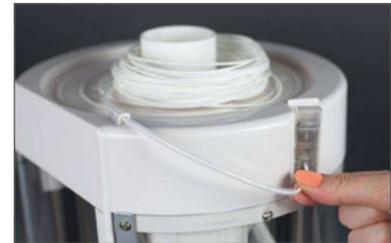
9. Insérez le filament dans l'ouverture du levier de chargement en appuyant légèrement jusqu'à ce qu'il s'arrête.
