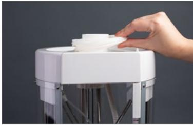
4. Placez la bobine du filament puis le filament sur le dessus de l'Alta.
