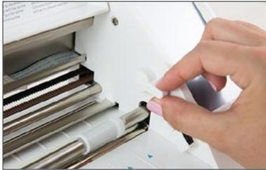
1. Localisez le levier de dégagement situé à droite et tournez-le vers vous. Quand le levier pointe vers le haut, le rouleau est en place et verrouillé. Tourné vers vous, la barre du rouleau se relève permettant de régler les rouleaux.
