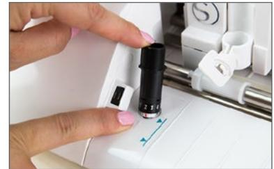
3. Pour procéder au réglage, insérez la lame dans l'ouverture située sur le socle de façon à aligner la flèche sur la ligne rouge de la lame. Un manchon à cliquet, fourni avec chaque lame, peut aussi être utilisé.
