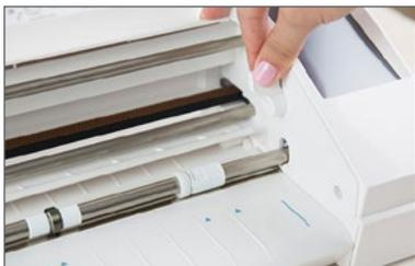
1. Localisez le levier de dégagement situé à droite et tournez-le vers vous. Quand le levier pointe vers le haut, le rouleau est en place et verrouillé. Tourné vers vous, la barre du rouleau se relève permettant de régler les galets.
