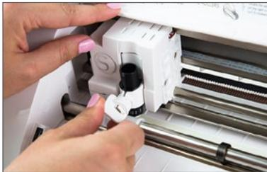
1. Tournez le bouton dans le sens inverse des aiguilles d'une montre et tirez pour dégager la lame du porte-outil.
