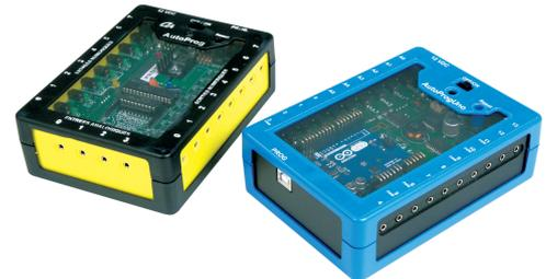
Le système AutoProg est une gamme de cartes capteurs / actionneurs que l'on connecte très simplement aux entrées ou sorties de l'interface, pour constituer facilement des systèmes automatisés.
