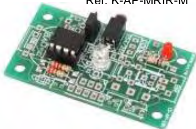
Module récepteur pour barrière infrarouge Réf. K-AP-MRIR-M
