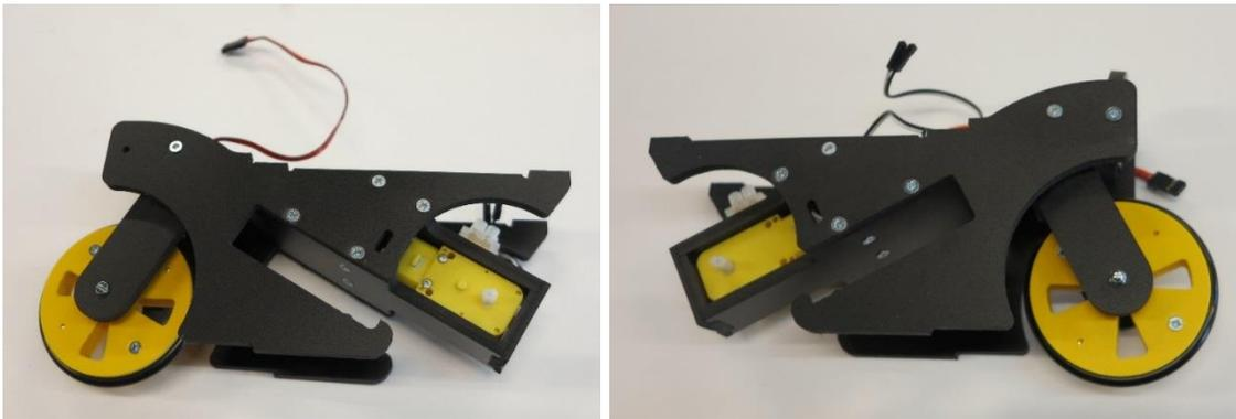
Monter chaque flanc du robot avec 5 vis TF 3x13.
