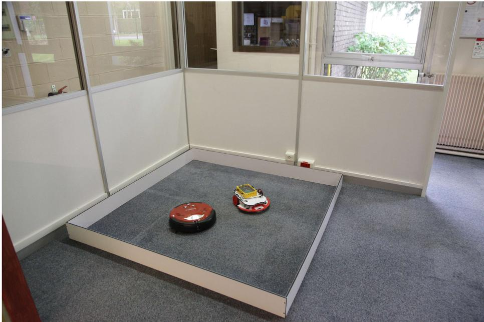
Le RoboMobile et le robot aspirateur réel dans un parc de test
