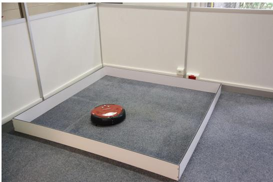
Robot aspirateur dans le parc de test (1,60 m x 1,60m)
