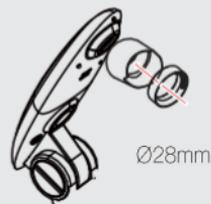
4. Installez / retirez l'adaptateur du microscope sur/de la lentille comme illustré sur l'image ci-dessous.
