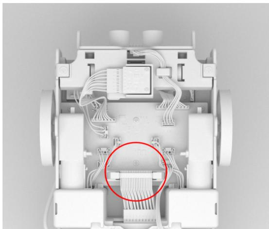
7. Insérez une des extrémités du câble I<sup>2</sup>C dans le circuit imprimé du Rover.
