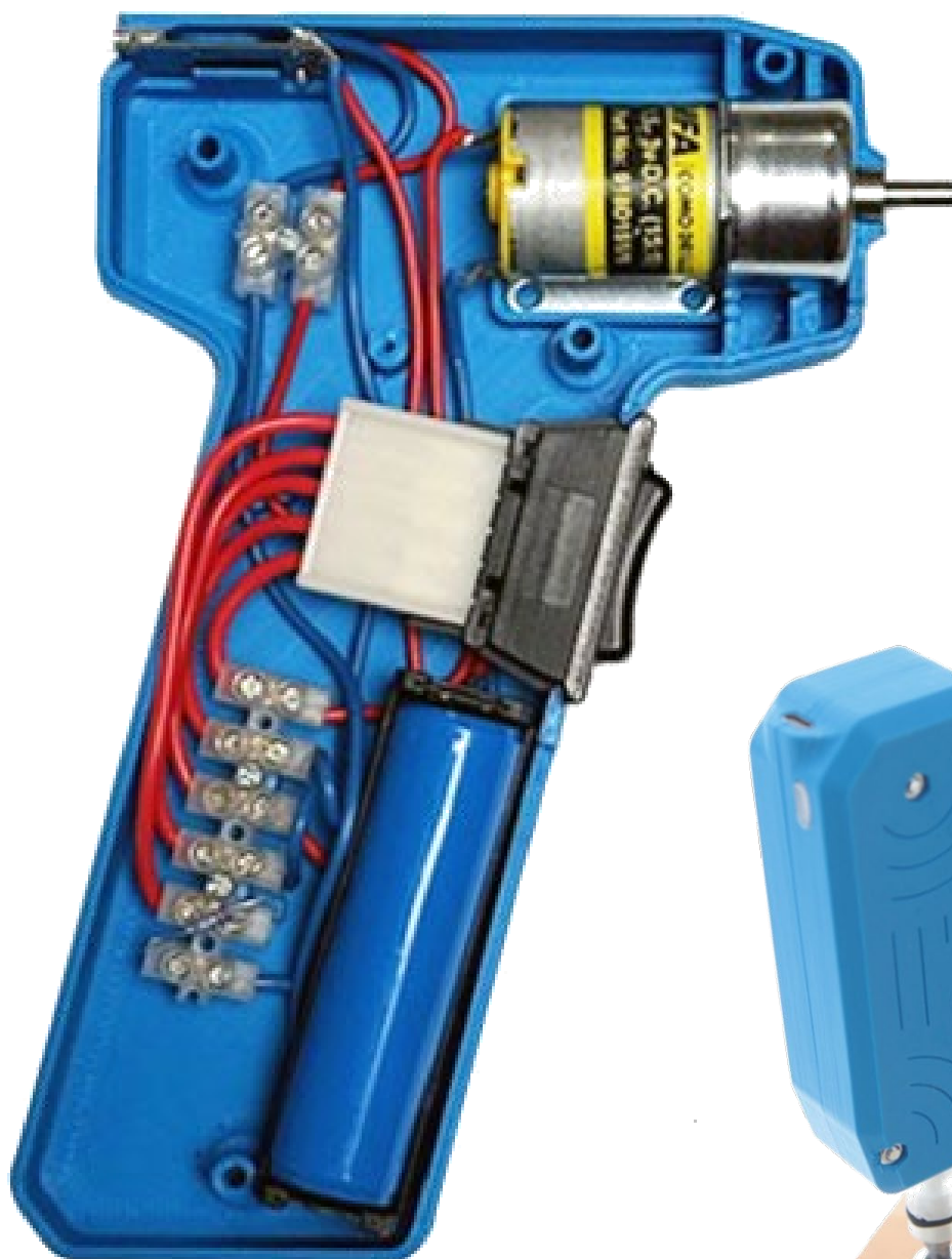
Photos coques ouvertes, éléments montés dans la demi-coque de gauche
